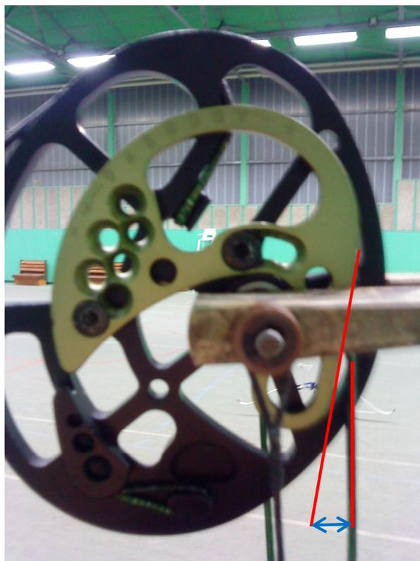
On voit très bien sur cette photo la désynchronisation de la came secondaire à pleine allonge. Il se forme un angle entre le câble et le plat de la poulie secondaire. Ces deux doivent être rigoureusement alignés pour un réglage et un confort de tir optimal.
